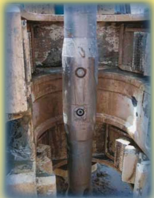
Forniamo batterie di aste monofluido Ø 60 – Ø 76 – Ø 90 e aste bifluido Ø 90 e siamo in grado di offrire soluzioni diverse a seconda della tipologia del terreno e delle esigenze del cliente.
