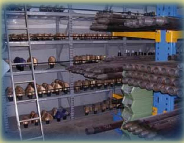
Il nostro magazzino è fornito di aste di perforazioni in diversi diametri sia saldate a frizione che saldate a filo; a seconda dell'esigenza del cliente il tubo può essere in N80/42CrMo4, i manicotti sono costruiti in 42 CrMo4 e i filetti sono lavorati su tamponi a normativa API. Su richiesta specifica dei nostri acquirenti, si possono avere aste particolari fornendo tamponi o disegni.
